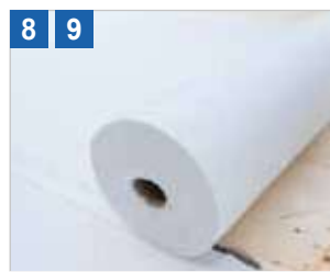
8) Erste Lage Vlies - 9) 22,5 x 96 mm Fasebretter Holzschalungsfläche
