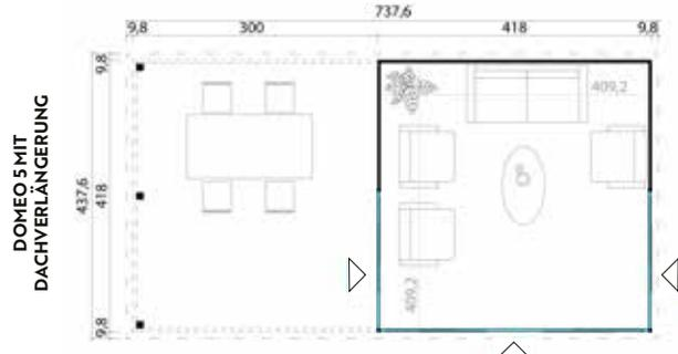
Optionale Dachverlängerung kann bei der naturbelassenen Ausführung rechts oder links montiert werden
