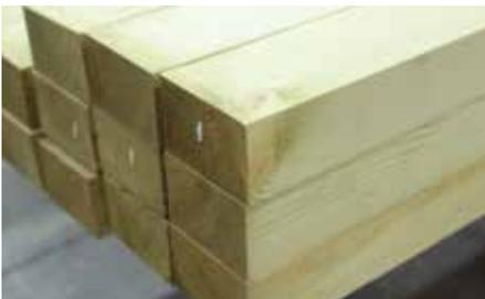
Imprägnierte Unterkonstruktion schützt das Holz gegen Feuchtigkeit und verlängert die Lebensdauer
