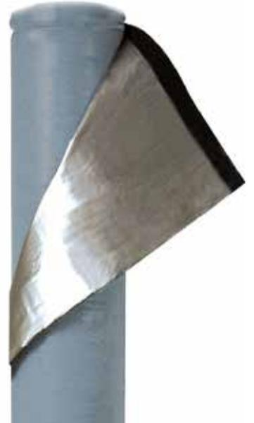
ONDULINE KSK-M ist eine kaltselbstklebende Dachbahn mit Aluminium-Oberschicht und einer besonders hohen Klebkraft. Die Verarbeitung ist einfach, sicher und schnell durchführbar. Die Aluminium-Oberfläche bietet einen hervorragenden Schutz gegen UV-Strahlung und andere Umwelteinflüsse. Der Untergrund muss trocken, tragfähig, frostfrei, fettfrei und abriebfest sein. Klebt nicht auf Silikon. Unebenheiten, Löcher und Ähnliches sind zu egalisieren. Dimension 500 x 100 cm
