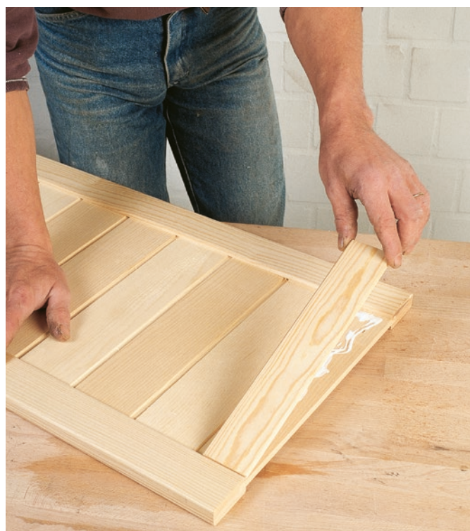
Möbelzuschneidetüren: Anleimen der Rahmenabschlussleiste
