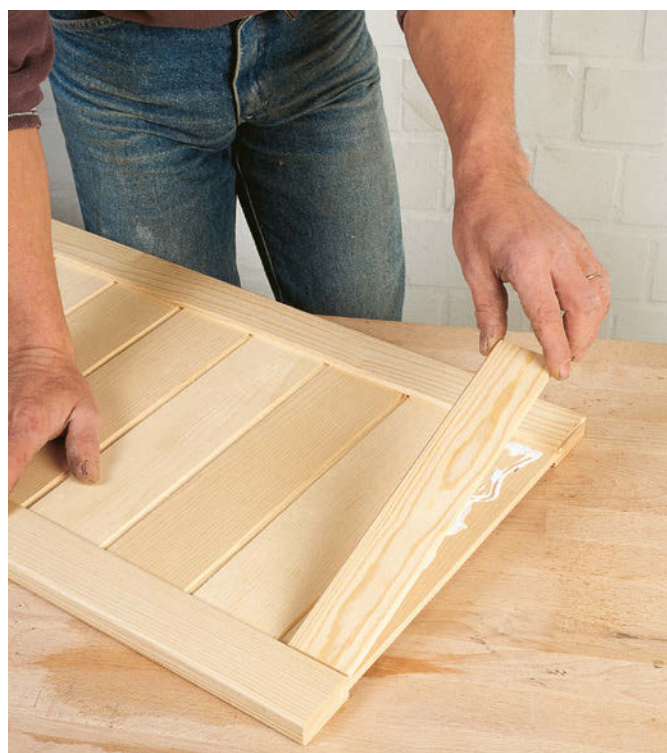
Möbelzuschneidetüren: Anleimen der Rahmenabschlussleiste
