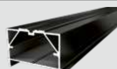
BIG-Isostep (Alu) 54 Terrassenlager Abstand Auflagepunkte max. 110 cm
