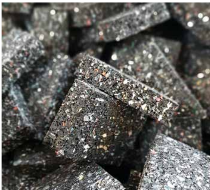
Isopads aus 95 % Altreifengranulat
