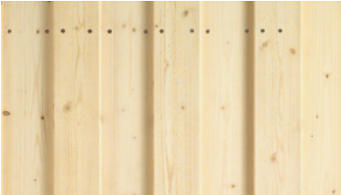
Glattkantprofil, Fichte, gesägt, 21 x 93 mm als Deckelprofil und 21 x 145 mm als Unterprofil
