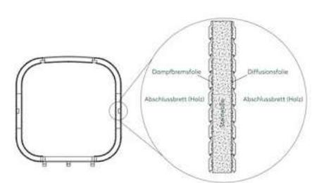
127 mm starke isolierte Dach- und Seitenwände
