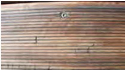
**Raue Stellen:** Trotz sorgfältiger Bearbeitung mit modernsten Maschinen lassen sich vereinzelte raue Stellen an der Holzoberfläche nicht vermeiden. Insbesondere bei Holzfasern, die gegen die Bearbeitungsrichtung verlaufen, z.B. um die Äste herum.
