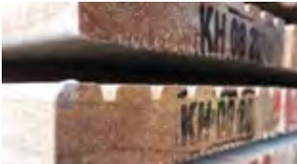
**Wachsschutz:** Um das Hirnholz vor eindringender Feuchte auf den langen Transportwegen zu schützen, wird ein Wachsfilm jeweils auf die Brettenden aufgetragen. Dieser ist vor der Verarbeitung mittels Kappschnitt zu entfernen, um Wacheinläufe in das Brett zu verhindern. Durch Wärmeeinwirkung würde das ansonsten passieren und ist optisch nicht schön. Wir empfehlen eine Nachbehandlung mit unserem Hirnholzschutz (keine Wachsbasis).
